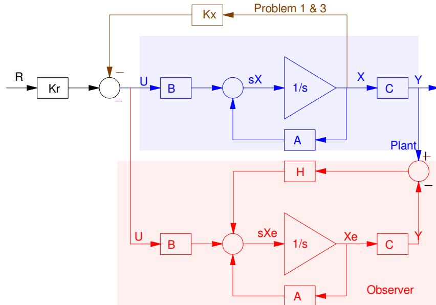
$$\begin{bmatrix} sX \\ sX_e \end{bmatrix} = \begin{bmatrix} A - BK_x & 0 \\ HC - BK_x & A - HC \end{bmatrix} \begin{bmatrix} X \\ X_e \end{bmatrix} + \begin{bmatrix} BK_r \\ BK_r \end{bmatrix} R$$
