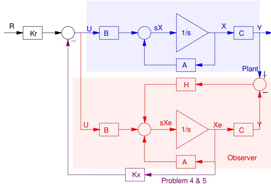
$$\begin{bmatrix} sX \\ sX_e \end{bmatrix} = \begin{bmatrix} A & -BK_x \\ HC & A - HC - BK_x \end{bmatrix} \begin{bmatrix} X \\ X_e \end{bmatrix} + \begin{bmatrix} BK_r \\ BK_r \end{bmatrix} R$$
