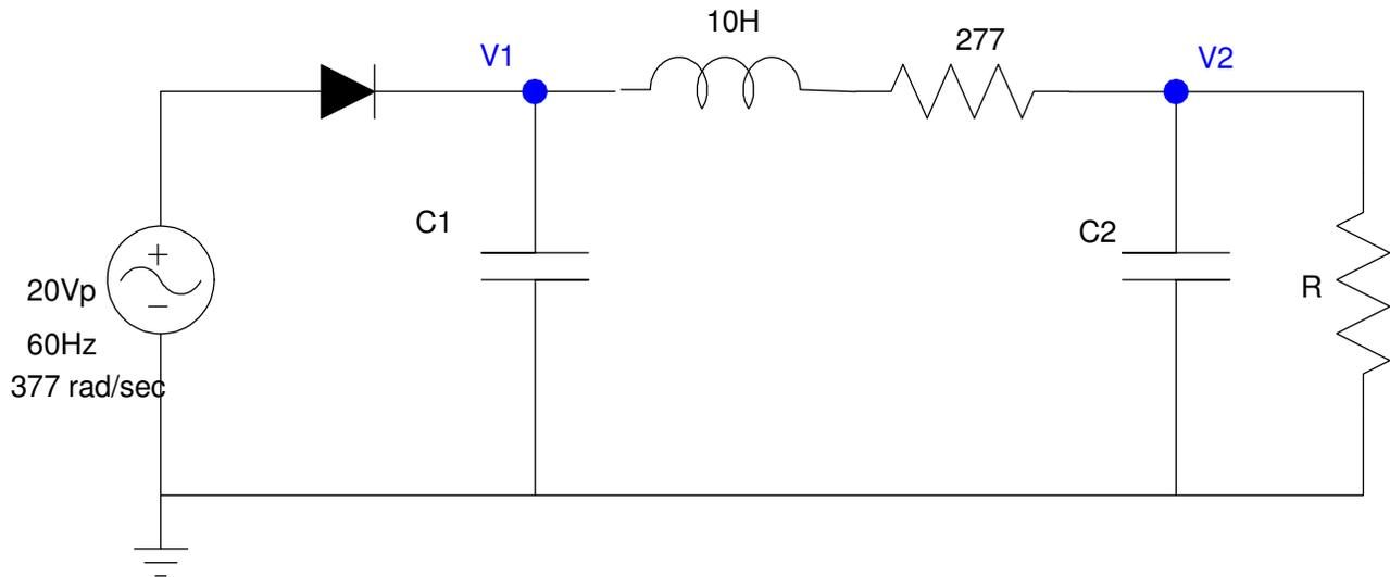
$$V_1(DC) = 19.3V - \frac{1}{2} \cdot 4V_{pp} = 17.3V$$
