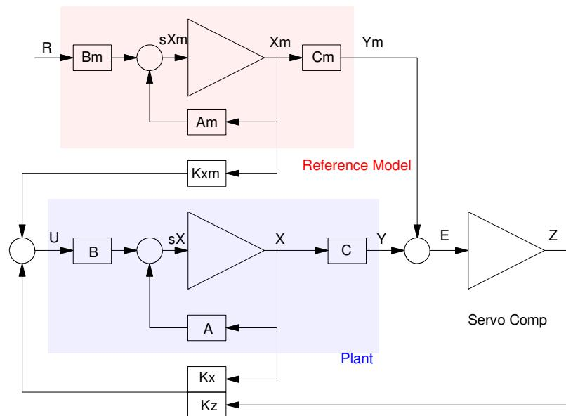
$$s \begin{bmatrix} X \\ Z \\ X_m \end{bmatrix} = \begin{bmatrix} A & 0 & 0 \\ C & 0 & -C_m \\ 0 & 0 & A_m \end{bmatrix} \begin{bmatrix} X \\ Z \\ X_m \end{bmatrix} + \begin{bmatrix} B \\ 0 \\ 0 \end{bmatrix} U + \begin{bmatrix} 0 \\ 0 \\ B_m \end{bmatrix} R$$
